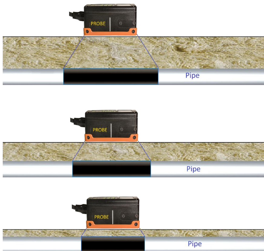
Рисунок 44. Зависимость размера области намагничивания от толщины изоляции.
