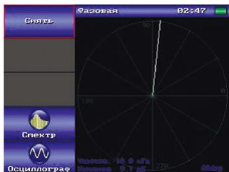
Рис.В. 5 Круговая диаграмма фазовой настройки
