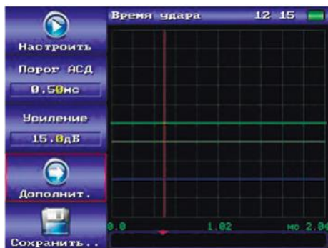
Рисунок D. 3 Основные параметры режима «Время удара»
