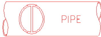
Рис. 10-1 Выравнивание ПЭП перпендикулярно к центральной оси трубы
