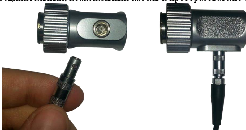
Рисунок 2.4 – Подключение совмещенного преобразователя к кабелю
