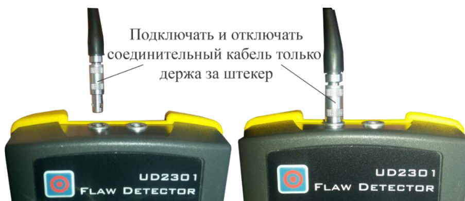
Рисунок 2.5 – Подключение совмещенного преобразователя к прибору
