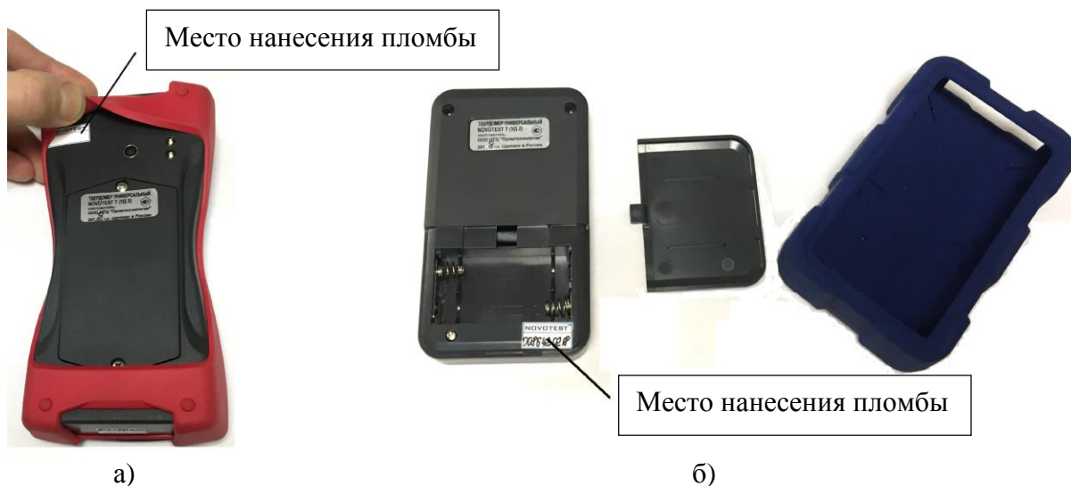
Рисунок 2 – Схема пломбировки от несанкционированного доступа а) для твердомеров модификаций Т-УД3, Т-У3, Т-Д3; б) для твердомеров модификаций Т-УД2, Т-У2, Т-Д2
