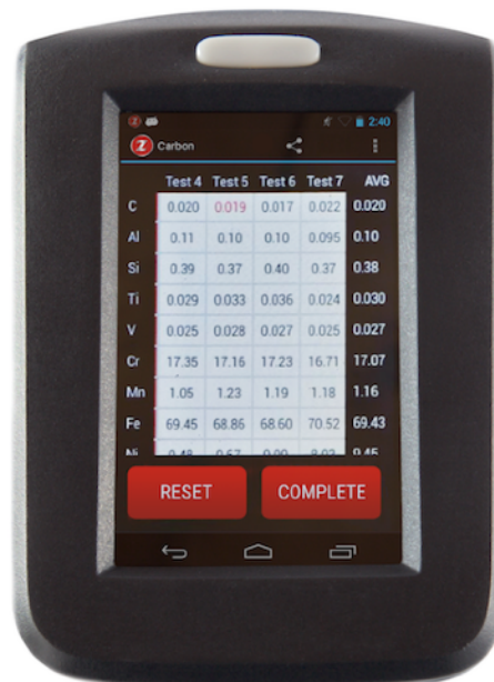
Рис. 4 Результаты последовательных замеров показаны на экране. Пользователь может удалить столбец, соответствующей любому замеру, чтобы удалить его из усреднения для финального результата теста, показанного в крайнем правом столбце
