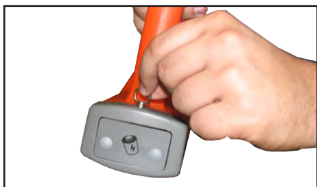
а) Выдвинуть фиксатор и освободить батарейный отсек
