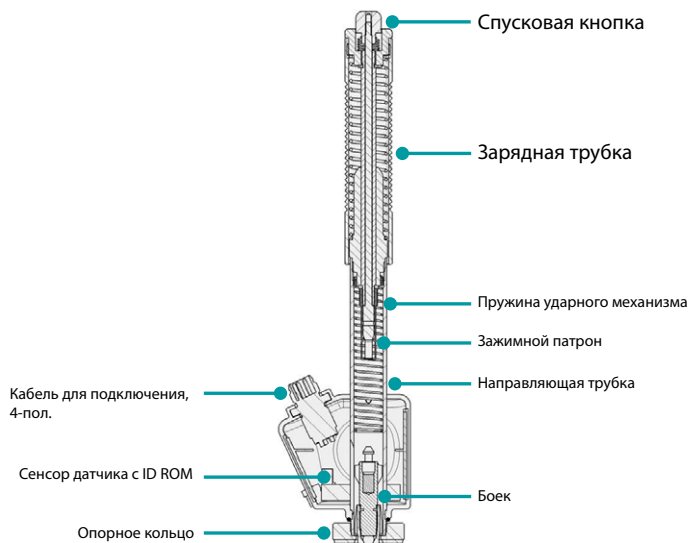
Рисунок 10: Схематический вид датчика Leeb
