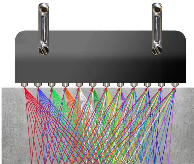
На рисунке условно показан принцип работы на последовательном комбинационном зондировании объекта контроля и последующей обработке полученных данных по алгоритму SAFT.
