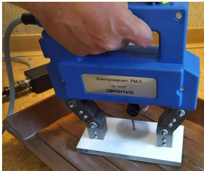
Рис. 1. Схема намагничивания контрольного образца МО-1
