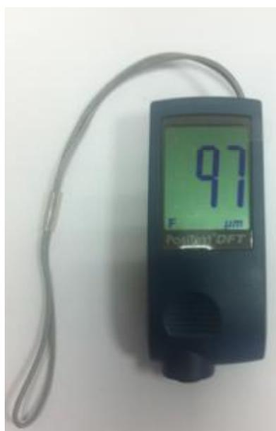
Рисунок 3 Толщиномер покрытий PosiTest DFT.
