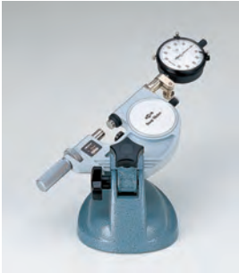
Пример применения: с индикатором часового типа
