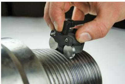
Рис. 14. Сканирование резьбы вихретоковым преобразователем, закрепленным в каретке
