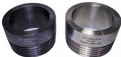
Рис. 17. Контрольные образцы дефектов резьбы для вихретоковой дефектоскопии: а — изготовленный из ферромагнитной стали 40Х, б — изготовленный из немагнитной стали NMS 100
