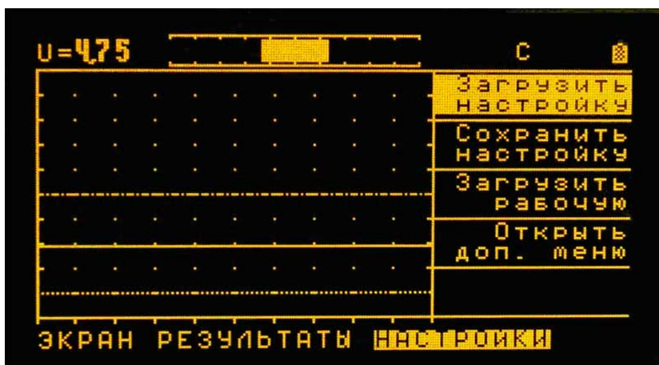
Рисунок 5 – Вид экрана дисплея дефектоскопа ВД-10А с выбранной группой параметров «Настройки» и параметром «Загрузить настройку»
