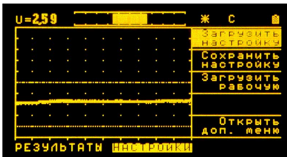
Рис. 10 – Вид экрана дисплея дефектоскопа ВД-10А при стандартном режиме работы индикаторов после завершения автоматической настройки. Преобразователь размещен на бездефектном месте детали
