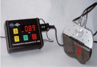
Рис. 2. Внешний вид структуроскопа УС-3ЦЛ
