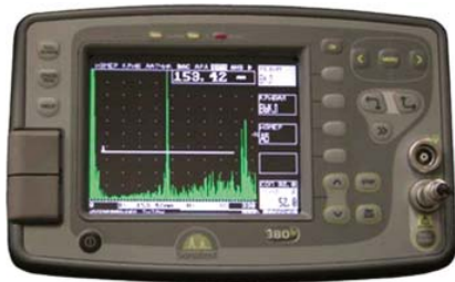
Рис. 6. Изображение на экране дефектоскопа MasterScan 380M при обнаружении усадочной раковины в средней части поперечного сечения титанового слитка
