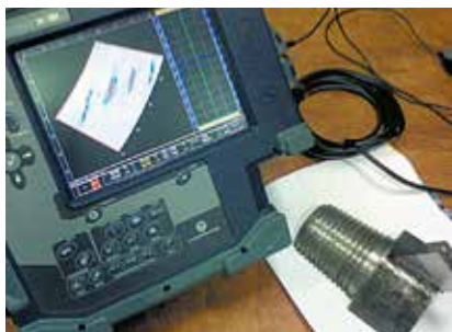
Рис. 9. Дефектоскоп X-32 и фрагмент КТН
