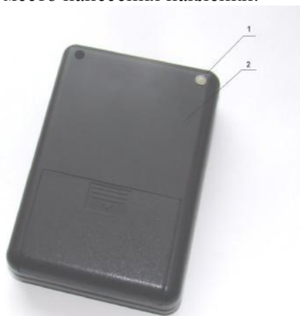
Рисунок 2 – Места пломбировки толщиномера
