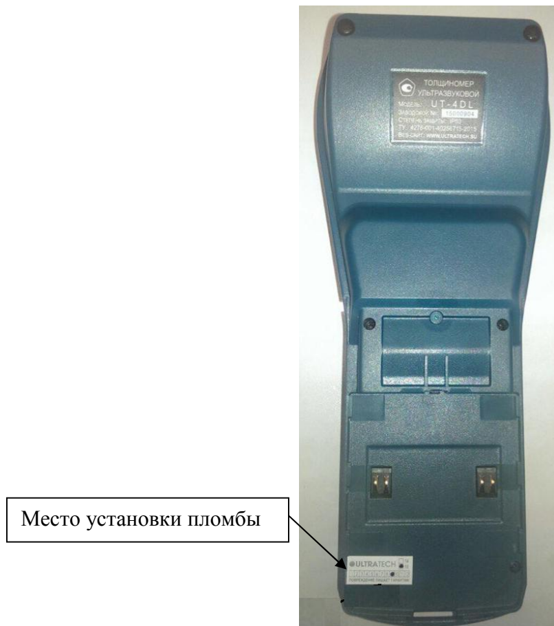
Рисунок 2 - Место пломбирования толщиномеров и место наклейки ярлыка
