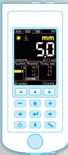
Применяется для оперативного определения толщины объекта контроля с отображением на экране прибора ранее сохраненных результатов (группы, ячейки в группах и результаты).
