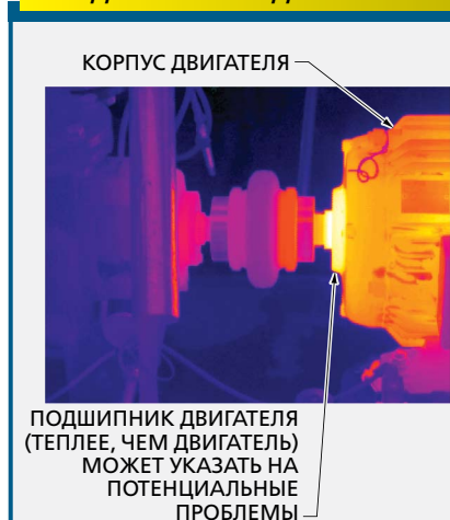
Рис. 2-2. Подшипник двигателя, который значительно теплее, чем корпус двигателя, указывает на возможные проблемы со смазкой или соосностью.
