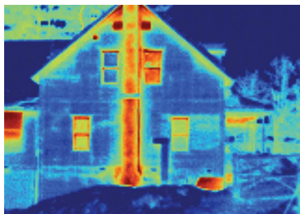
Рис. 5-48. Тепловое изображение наружного вида здания может четко указать на проблемные зоны, такие как светлые участки, где отсутствует теплоизоляция.
