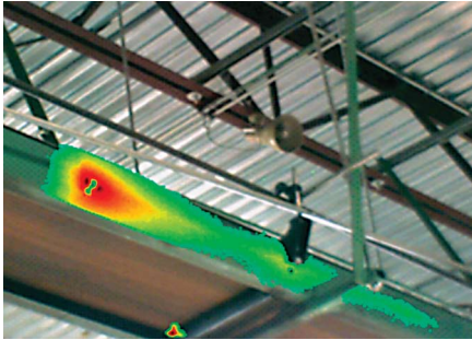
Рис. 5-67. Трение ленты подвешенного конвейера создает перегрев на тепловом изображении. Лента перекашивается из-за изношенного подшипника в ролике. В результате повышенное трение приводит к перегреву приводного двигателя.
