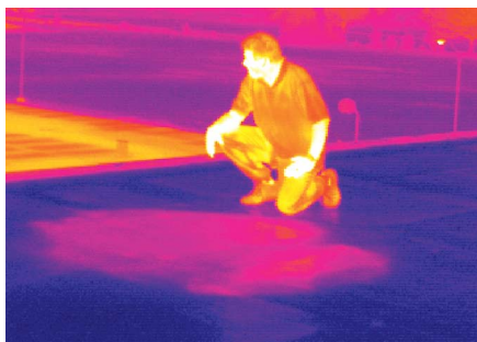
Рис. 5-53. Область с влажной теплоизоляцией крыши проявляется в виде теплого участка на крыше ранним вечером, когда условия самые подходящие для тепловизионной съемки.
