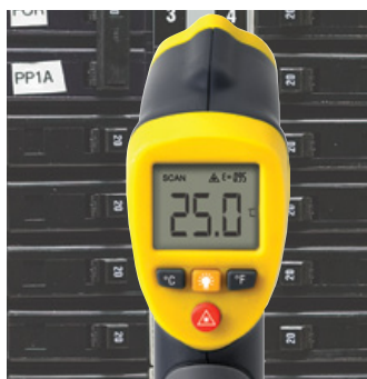
ИК-термометр: измерение температуры в одной точке
