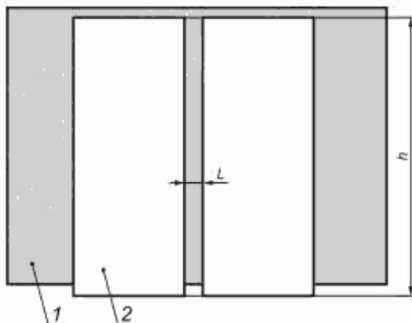
1 — протяженный излучатель; 2 — тепловой тест-объект толщиной 1 мм с переменной щелью (высота шторки  $h = \text{const}$ , расстояние между шторками  $L$  меняется от 0 до 50 мм, с шагом 1 мм)
