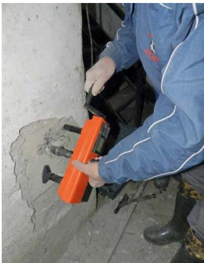
Определение прочности бетона механическим методом отрыва со скалыванием с использованием прибора ОНИКС-ОС
