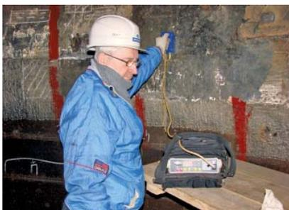
Коэрцитометрические измерения на обечайке камеры рабочего колеса с помощью структуроскопа КРМ-Ц-К2М
