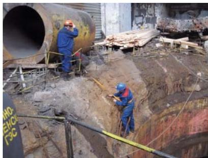
Оценка состояния бетона после аварии на Саяно-Шушенской ГЭС ультразвуковым методом
