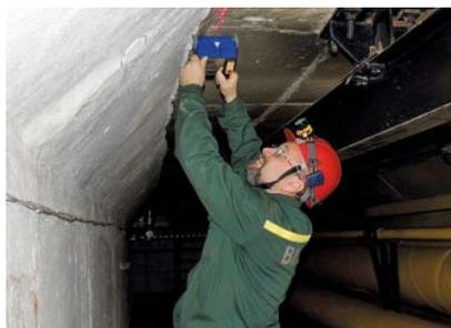
Поиск арматуры в стене с помощью георадара-Бетоноскопа СК-1700
