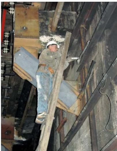
Контроль прочности бетона с помощью склерометра стены Ирганайской ГЭС после пожара
