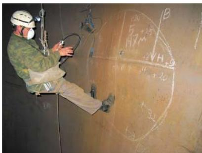
Инструментальный контроль металла напорного водовода Саяно-Шушенской ГЭС при помощи верхолазов
