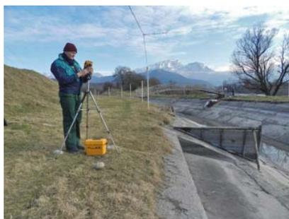
Тепловизионное обследование плит крепления грунтовых откосов канала
