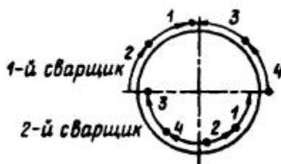
Рис. 7.17. Порядок наложения валиков при сварке первого слоя стыков труб диаметром 1200 мм и более:
