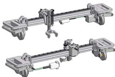
Рис. 3. Сканер для выполнения толщинометрии основного металла
