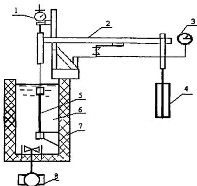
1-стрелочный индикатор, 2-рычаг для передачи силы; 3-прибор для учета времени, 4-контрольный груз; 5-образец, 6-испытуемая среда, 7-теплоизолированная ванна, 8-насос для циркуляции жидкости
