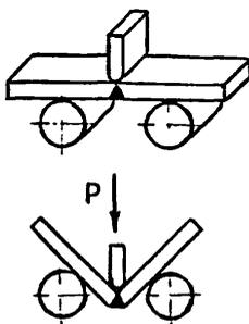
Рисунок И 1 - Схема испытания на статический изгиб
