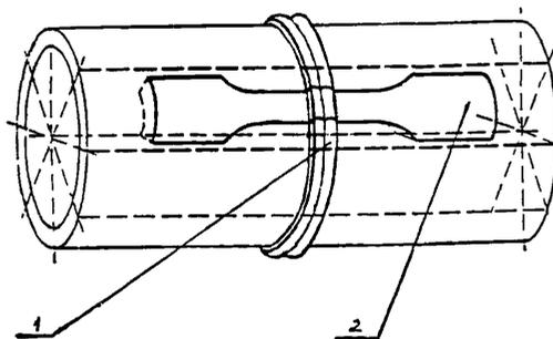
1 - патрубок со сварным соединением, 2 - расположение образцов
