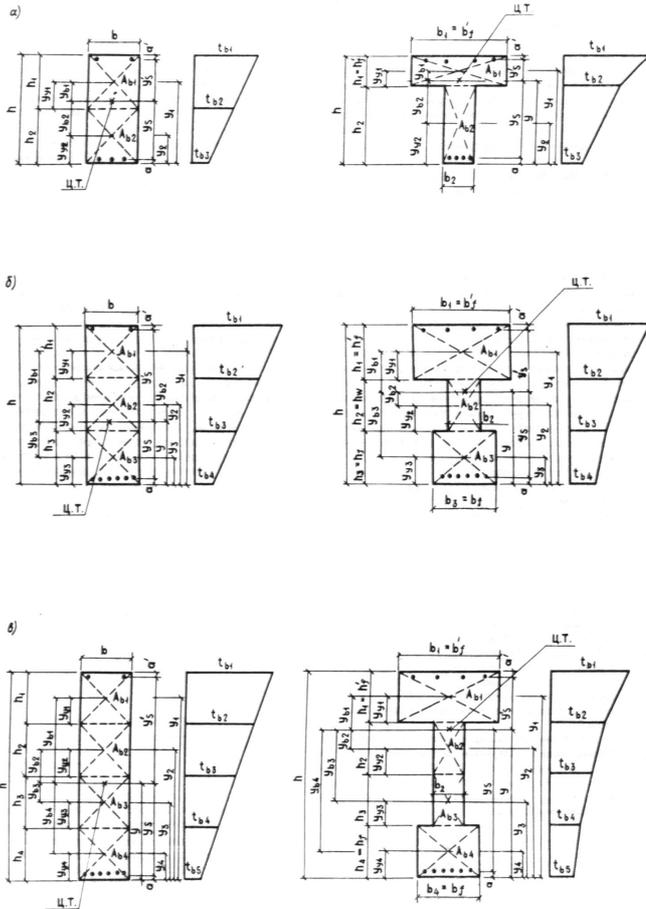
Черт. 1. Схемы разбивки на части высоты прямоугольного, таврового и двутаврового сечений элементов
