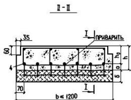
Черт. 10. Конструкция изгибаемого железобетонного элемента, нагреваемого до температуры более 400°C со стороны растянутой зоны
