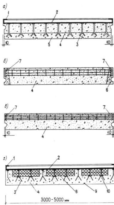
Черт. 11. Конструкция панелей из легкого жаростойкого бетона
