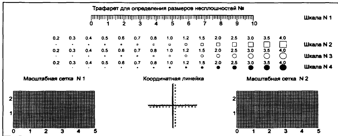
Рис. 1. Трафарет для оценки размеров изображений несплошностей
