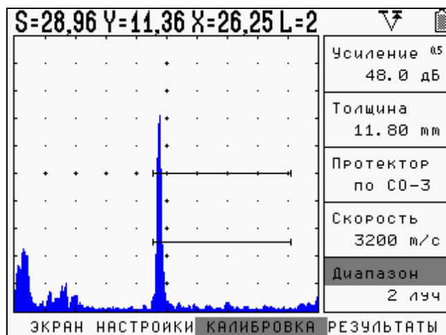
Калибровка для контроля по однократно отраженному лучу
