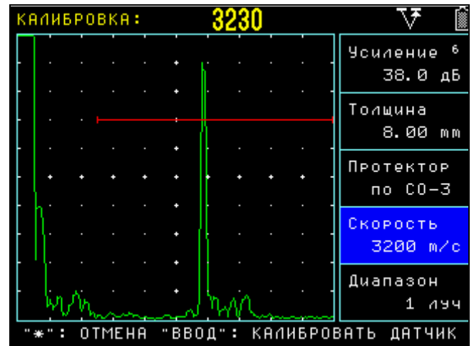
рис.3-13 Калибровка скорости в образце
