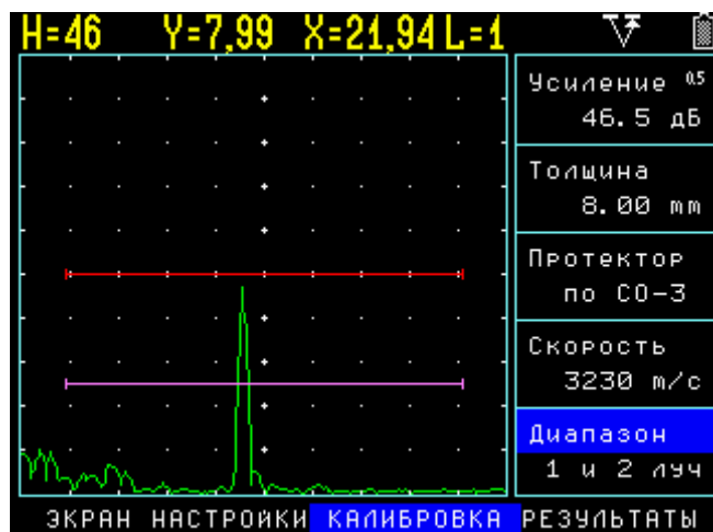
б) Калибровка диапазона для отображения и прямого и однократно отраженного лучей
