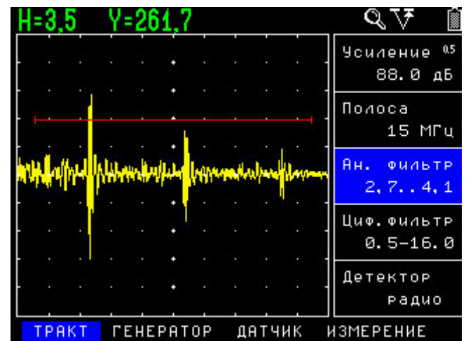
б) Сигналы после включения аналогового фильтра 2,7-4,1 МГц.
