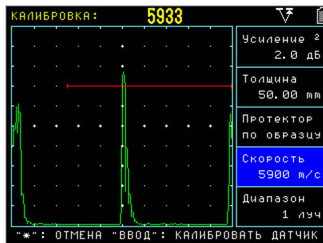
рис.3-11 Калибровка скорости распространения продольных УЗ колебаний в образце толщиной 50мм
