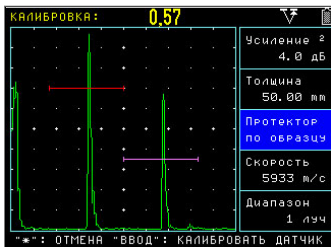
рис.3-10 Экран калибровки прямого преобразователя по плоскопараллельному образцу толщиной 50мм
