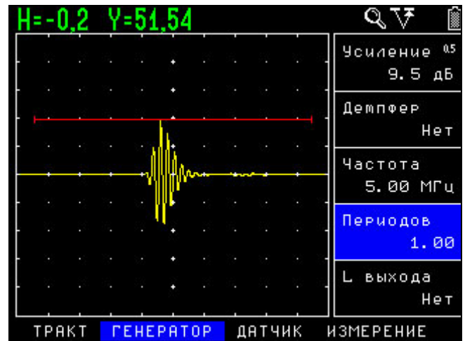
а) Стандартный преобразователь 5МГц. Возбуждение 1 периодом частоты
