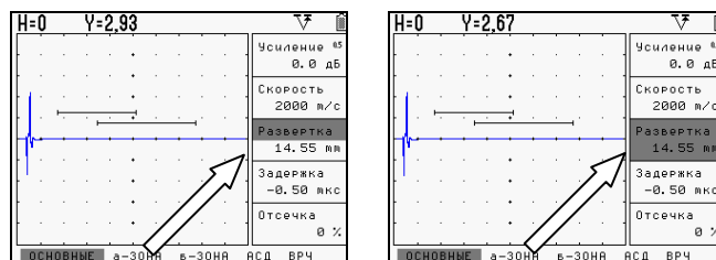
Рис 1-11 Режимы работы меню дефектоскопа (слева – режим выбора параметра; справа – режим изменения параметра работы)
