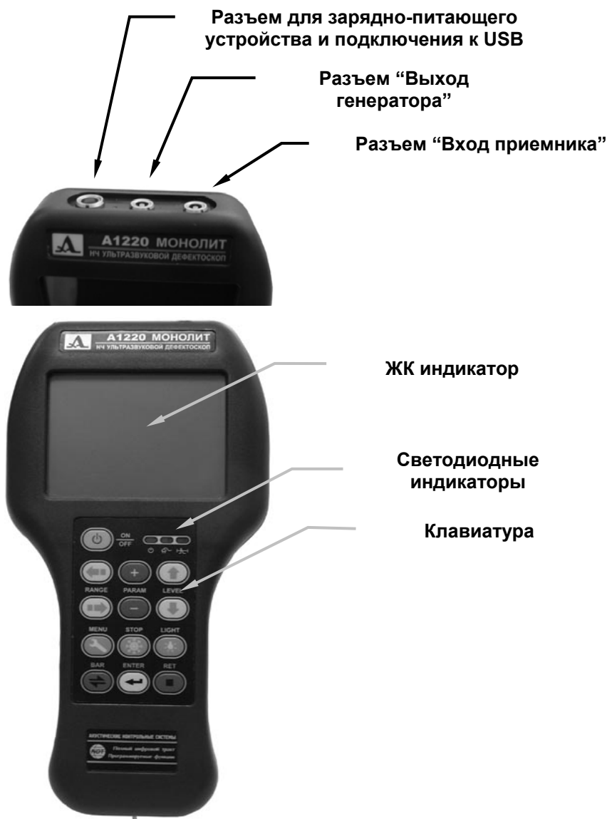
Рис. 2.1. Электронный блок дефектоскопа
