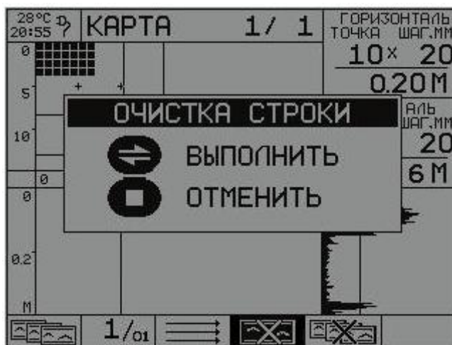
Рис. 3.9 Экран прибора в режиме КАРТА при включенной пиктограмме очистки строки
