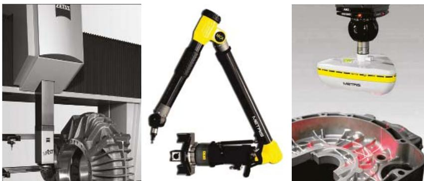
Рис. 5. Внешний вид контактной координатно-измерительной машины PRISMO navigator фирмы Carl Zeiss, переносной портативной «измерительной руки» и трехмерного лазерного бесконтактного сканера рXC650Dx фирмы Nikon Metrology
