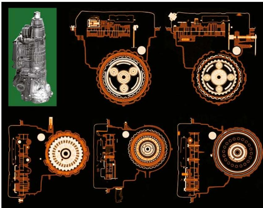
Рис. 9. Внешний вид и высоко-энергетические (5 МэВ) томограммы  $\varnothing 600$  мм поперечных сечений автоматической коробки передач Subaru
