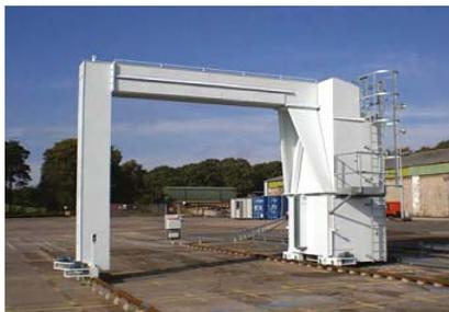
Рис. 3. Внешний вид высокоэнергетического (6 МэВ) портального досмотрового рентгенографического оборудования типа Rapiscan Eagle P60 американской фирмы Rapiscan Systems
