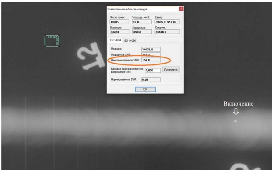
Рис. 1. Сталь 5 мм, снимок на пластины высокого разрешения
