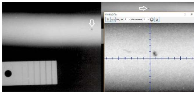
этому в несколько раз увеличивается производительность труда оператора-дефектоскописта. Производительность испытанного АПК по сравнению с традиционным способом увеличивается минимум в 2–4 раза.
