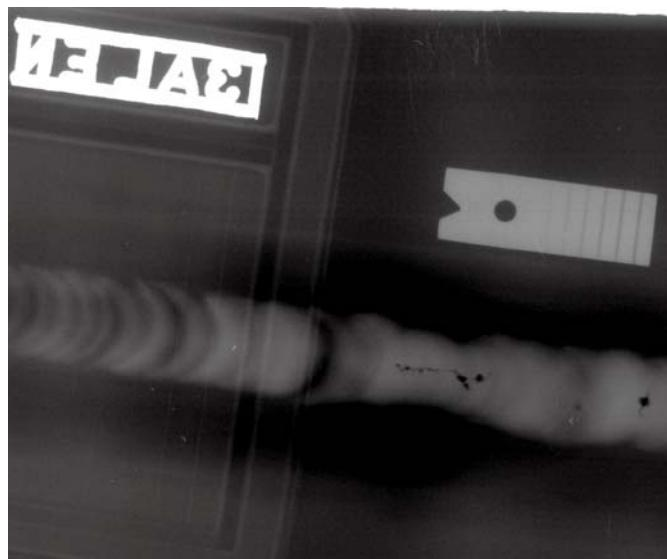
Рис. 4. Al 5 мм, снимок на пластины высокого разрешения. Вид после применения цифрового фильтра «Литьё»
