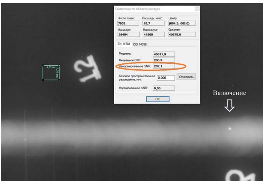
Рис. 2. Сталь 5 мм, снимок на пластины стандартного разрешения
