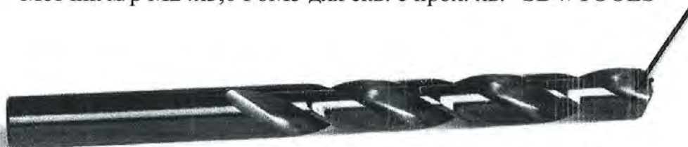
Образец №3 (только проверка на твердость) Сверло цх вышлифованное 12мм Класс A1 P6M5K5 «SDW TOOLS»
