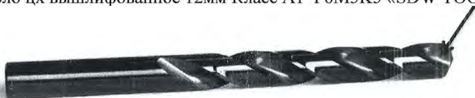
Образец №4 (только проверка на твердость) Сверло цх вышлифованное 8,0мм Класс A1 P6M5K5 «SDW TOOLS»
