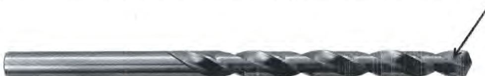
Образец №6 (только проверка на твердость) Сверло 9,0мм цх вышлифованное Класс A1 P6M5 «SDW TOOLS»
