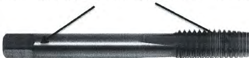
Образец №2 (проверка на химический состав сплава и твердость в 2 местах) Метчик м/р M24x3,0 P6M5 для скв. с прох. хв. «SDW TOOLS»
