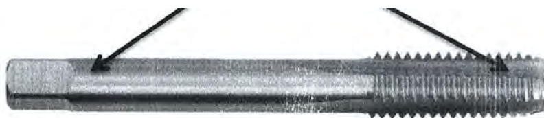
Образец №1 (проверка на химический состав сплава и твердость в 2 местах) Метчик м/р M27x1,0 P6M5 для глух. с прох. хв. «SDW TOOLS»
