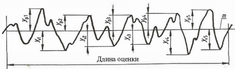
Рис. 12.2 Параметр R_z (ASME В46.1-1985, ISO 4287/1-1984, JIS В0601-1994, ГОСТ 25142-82)
