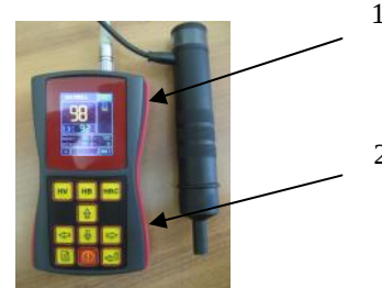
Рисунок 4. - схема пломби- модификации ТКМ-459С 1,2 - места пломбировки
