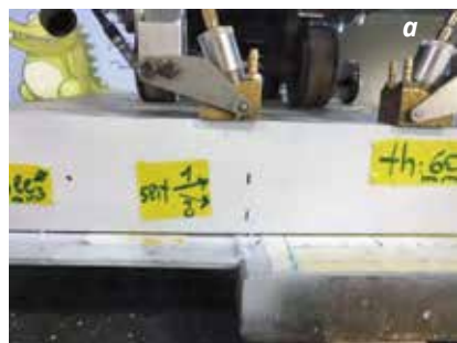
Рис. 3. Калибровочный блок (а) и специальный сканер для TOFD (б)
