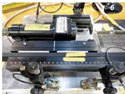
Рис. 3. Калибровочный блок (а) и специальный сканер для TOFD (б)
