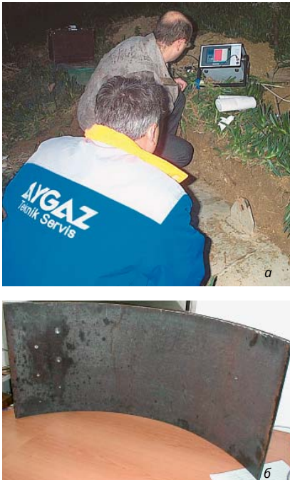
Рис. 6. Образец, используемый для настройки чувствительности при контроле подземных цилиндрических резервуаров для хранения сжиженного газа (а) и процесс сканирования резервуара (б)
