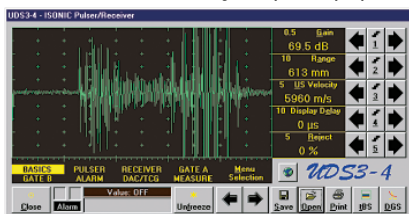
Рис. 9. Пачка импульсов на приемном преобразователе при реализации технологии CHIME (расстояние между преобразователями 32 см, толщина стенки 20 мм) продольной волн соответственно
