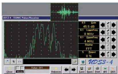
Рис. 2. Спектральная функция сигналов при использовании технологии LRGWI характеризуется несколькими максимумами, обусловленными свойствами объекта контроля
