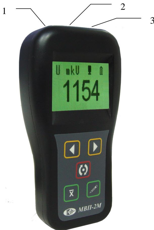
Рисунок 1 Внешний вид прибора МВП-2М
