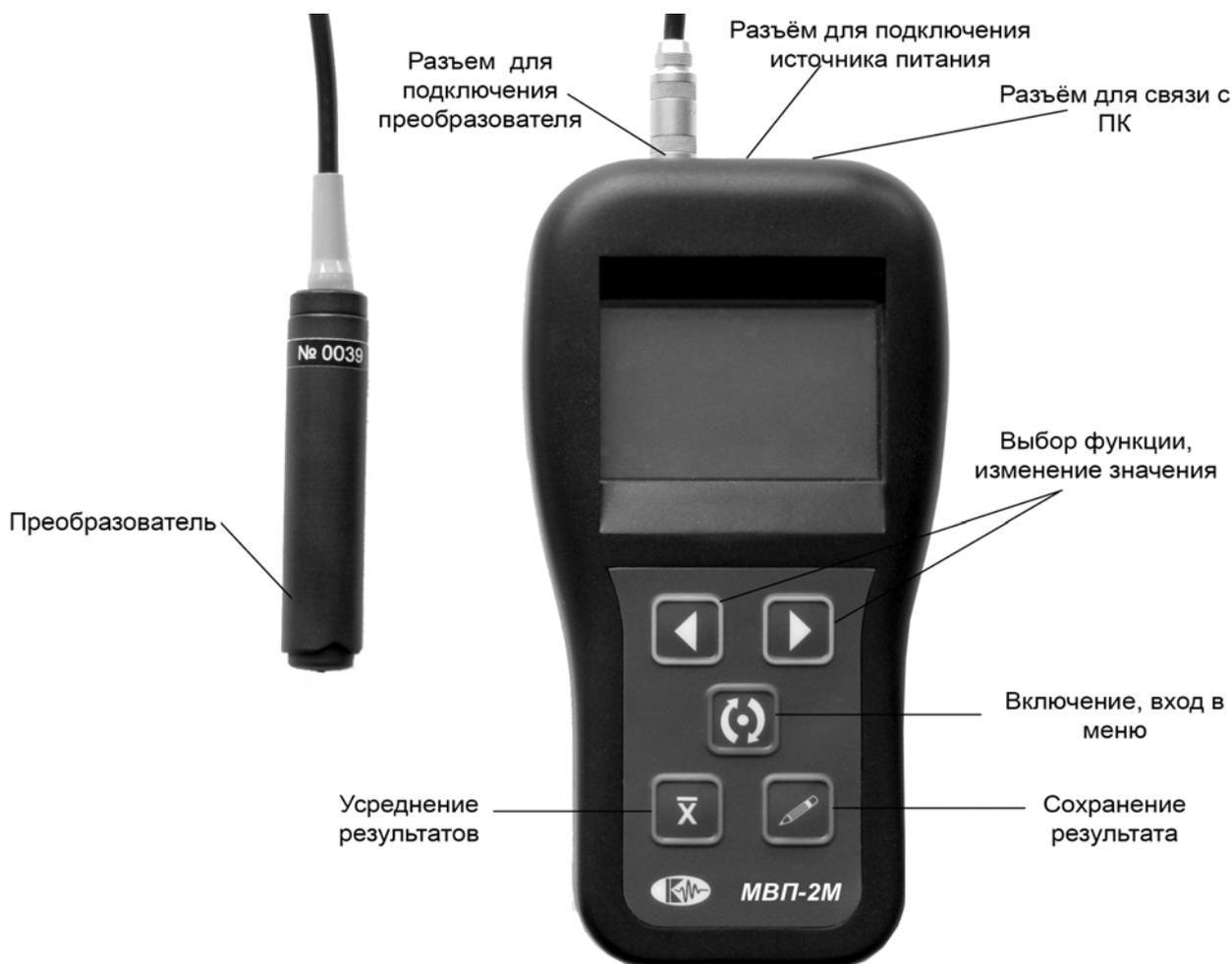
Рис. 1-3 Клавиатура многофункционального выхретокого прибора
