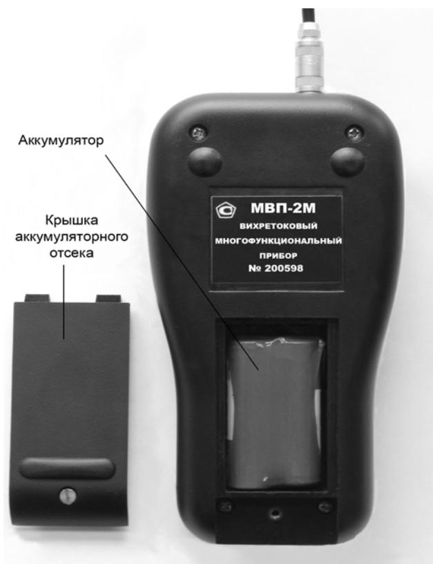
Рис 1-1 Вид прибора сзади
