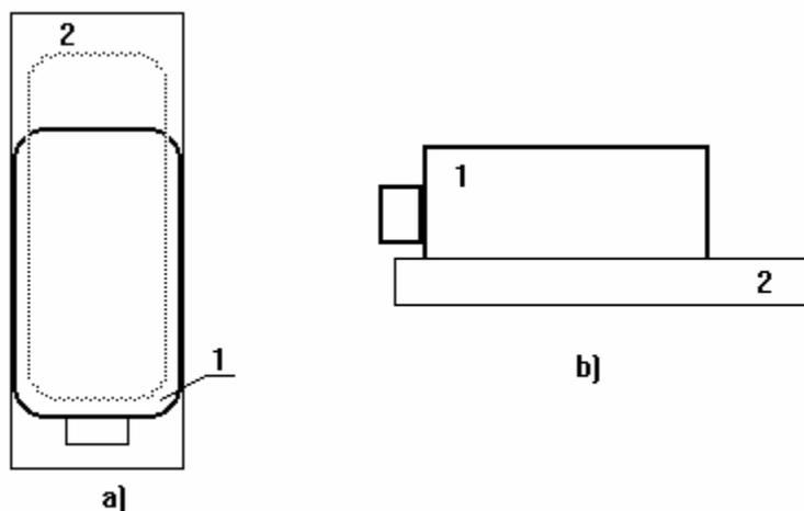
Рис.1. Способ создания стабильного зазора между преобразователем и поверхностью образца. а- вид сверху, b - вид сбоку, 1- преобразователь, 2 - прокладка.
