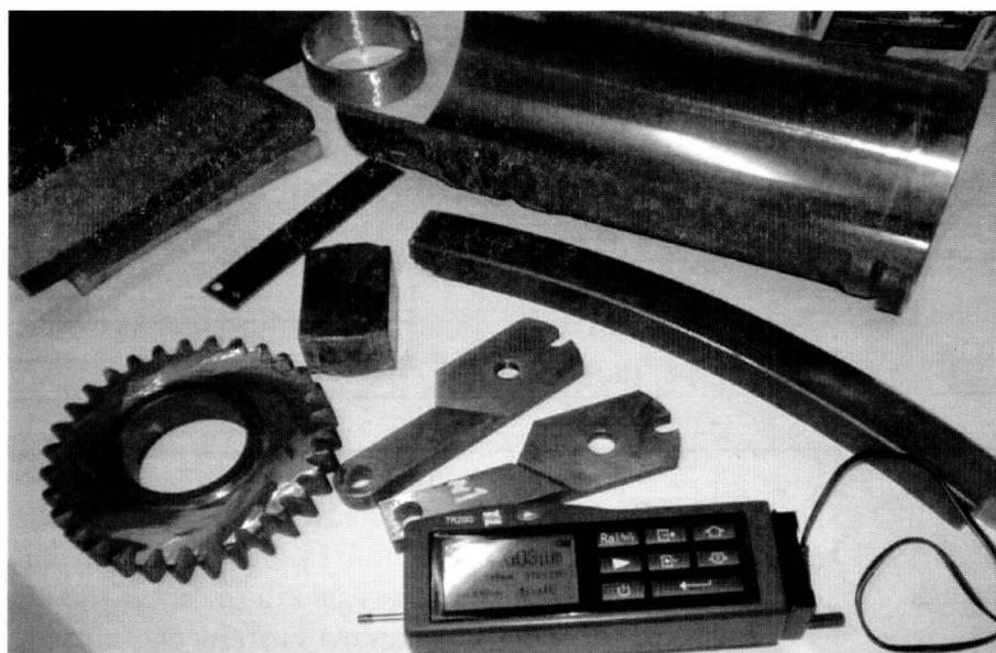
Рис. 2. Экзаменационные образцы и измеритель шероховатости TR200
