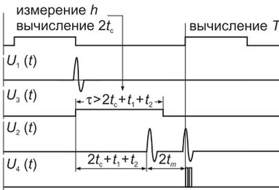
Рис. 3. Временная диаграмма, описывающая алгоритм функционирования комбинированного преобразователя при измерении остаточной толщины металла
