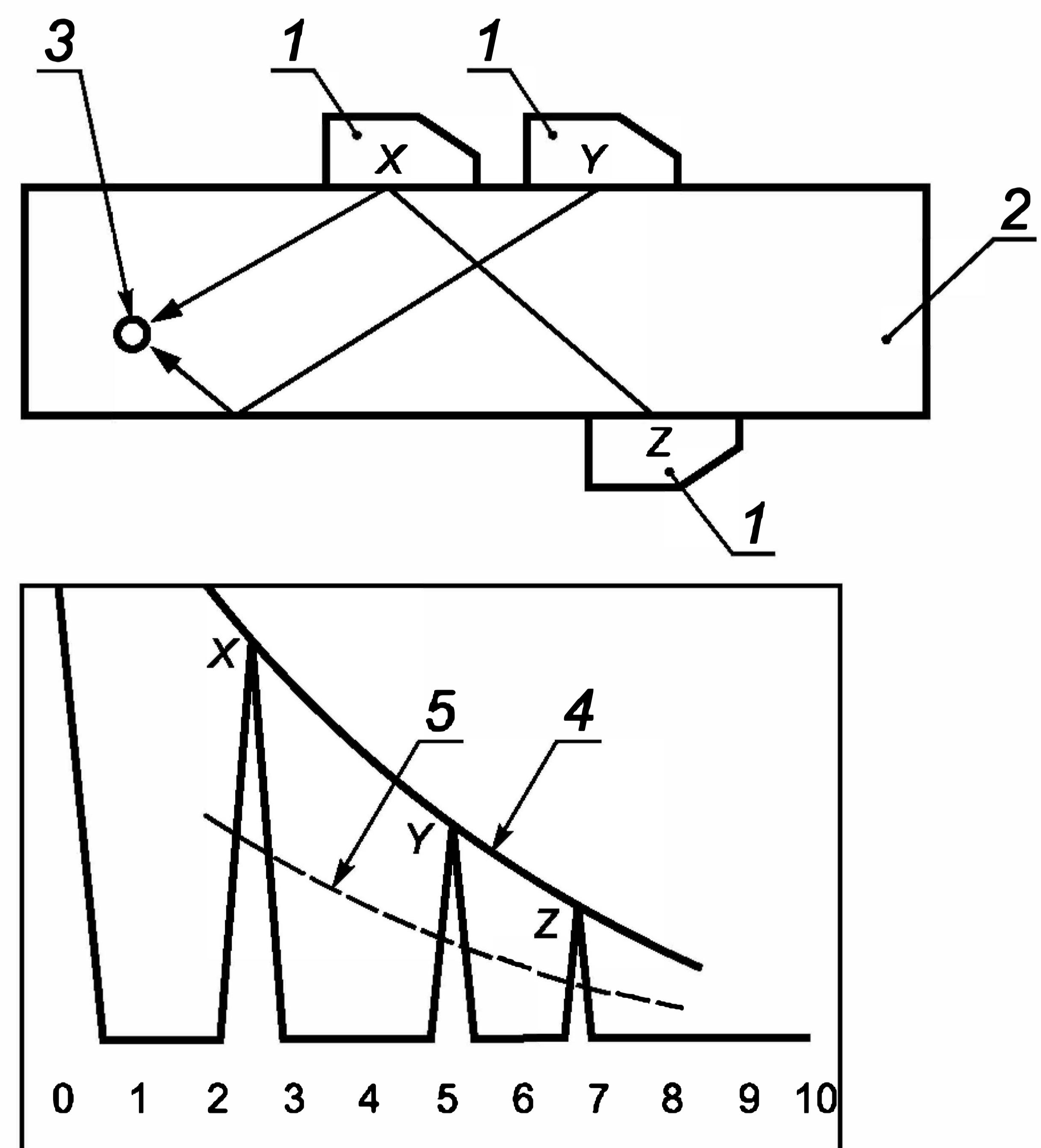
1 — наклонный преобразователь (2.5.1); 2 — контрольный образец (2.7.3); 3 — контрольный отражатель (2.7.4), боковой цилиндрический отражатель (2.7.5); 4 — кривая корректировки амплитуда-расстояние (APК-кривая) (2.12.4); 5 — уровень 50 % APК-кривой; X, Y, Z — положение преобразователя
