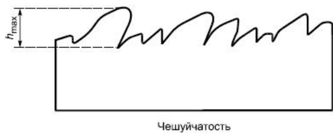
Рисунок А.35 - Чешуйчатость сварного шва
