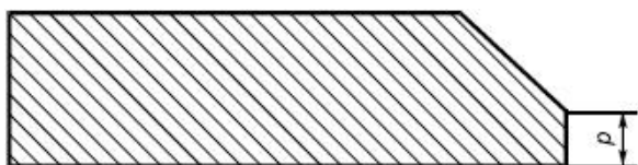
Рисунок Г.6 - Схема измерений притупления кромок r
