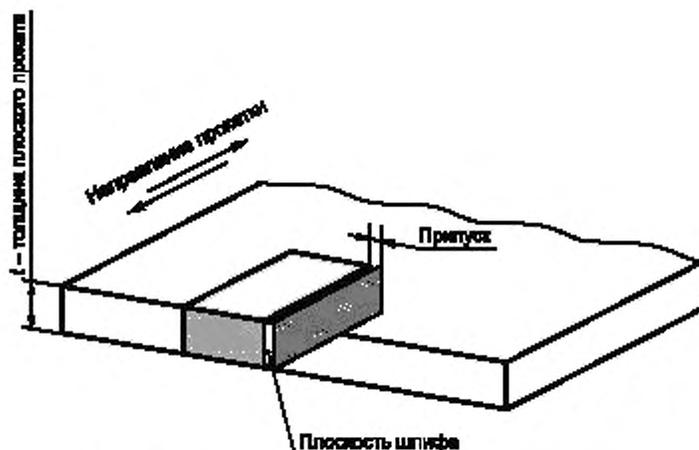
Рисунок 1 — Схема вырезки образцов из плоского проката
