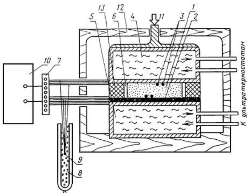
1 - образец грунта; 2 - тепломер; 3 - датчики температуры; 4 - верхняя термостатированная плита; 5 - нижняя термостатированная плита; 6 - обойма из органического стекла; 7 - переключатель; 8 - сосуд Дьюара; 9 - спай сравнения; 10 - потенциометр; 11 - прижимное устройство; 12 - теплоизоляционный кожух; 13 - поролон
