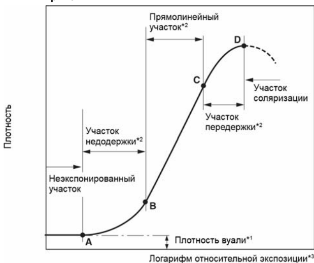
Рис. 10 Обозначение пяти участков на характеристической кривой
