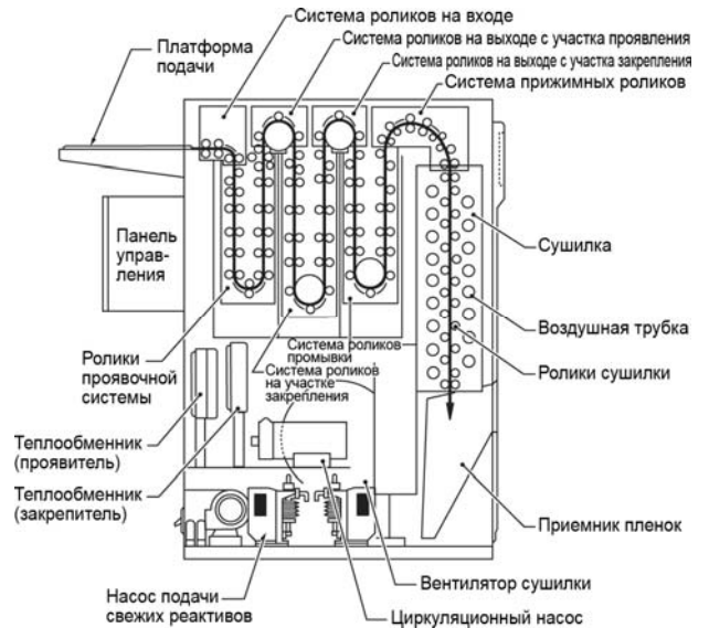
Рис. 28 Вид проявочного автомата Fuji FIP 7000 в разрезе
