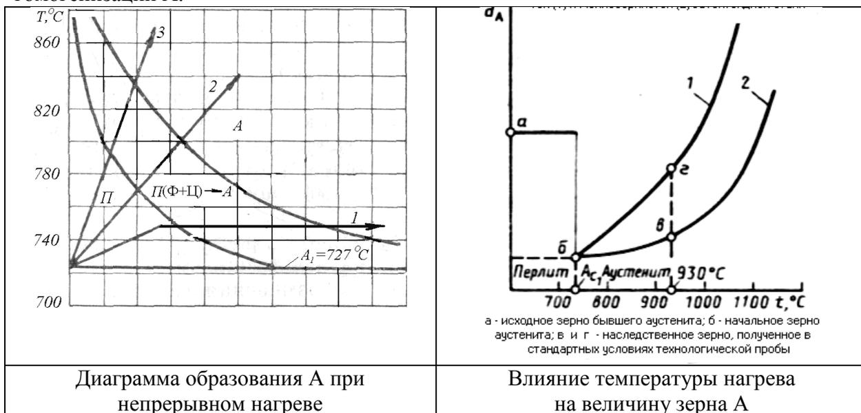
Для доэвтектоидных сталей: 1) начало ФП, 2) исчезновение Ц, 3) исчезновение Ф избыточного (при нагреве выше  $A_{C3}$ ), 4) гомогенизация.
