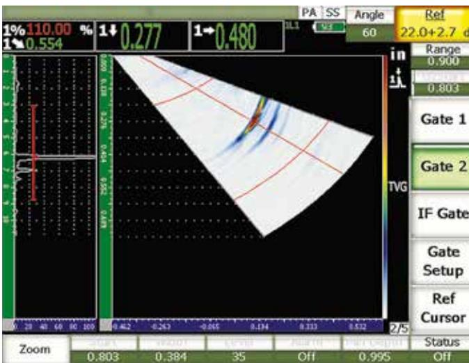
Рис. 3. Типичное В-скан изображение, получаемое способом качающегося луча на экране большинства ФР-дефектоскопов (его также называют S-скан)
